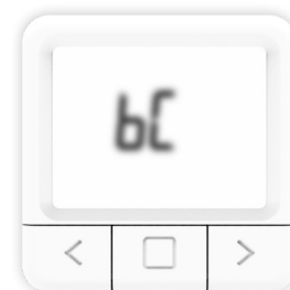
Das Symbol bC beginnt zu blinken beim Eintritt in den BluetoothConnect modus
