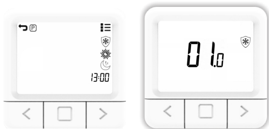
Panoramica della schermata per l'impostazione della temperatura di sbrinamento
